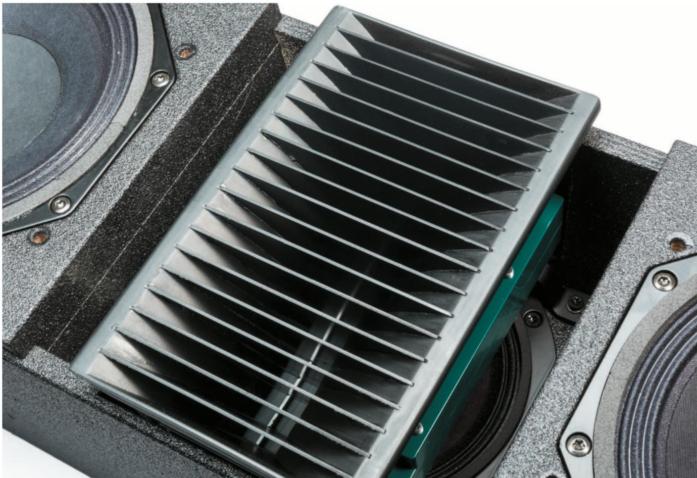
**Der Mitteltöner** liegt hinter dem Hochtöner mitsamt seinem Waveguide – alles zusammen wirkt wie eine Art Bandpasskammer vor dem Mitteltöner, die (passend abgestimmt) die Sensitivity deutlich erhöht
